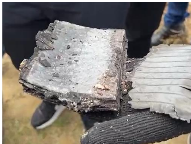
Figura 78 a 81 - Fonte: autor (2025), mostram partes internas das placas de chumbo da bateria, após queima total do veículo, onde apresentam fusão, curto-circuito interno e formação de contaminantes.
