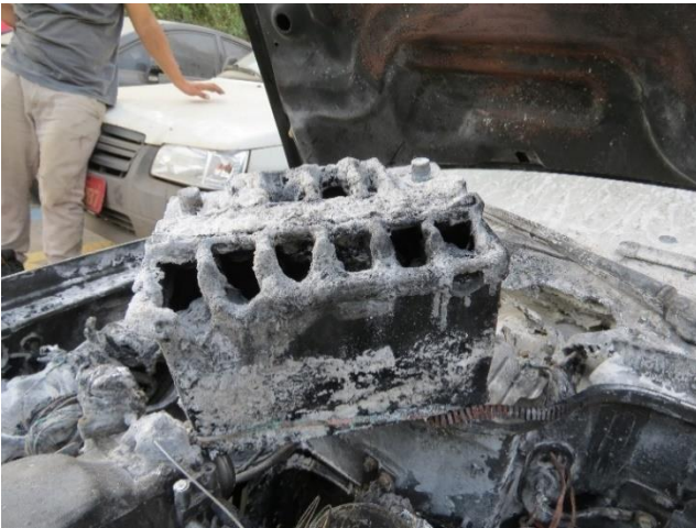
Figuras 46 e 47 - Fonte: autor (2025) – Setas vermelhas mostram polos positivo e negativo da bateria, sem anormalidades técnicas por derretimento.
