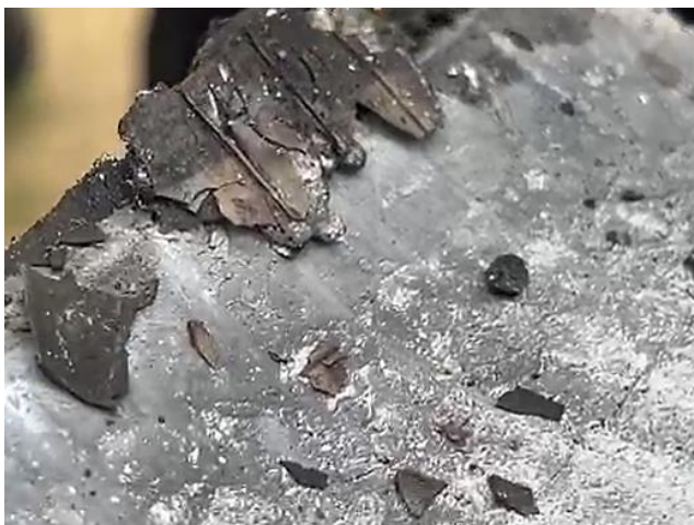
Figura 78 a 81 - Fonte: autor (2025), mostram partes internas das placas de chumbo da bateria, após queima total do veículo, onde apresentam fusão, curto-circuito interno e formação de contaminantes.
