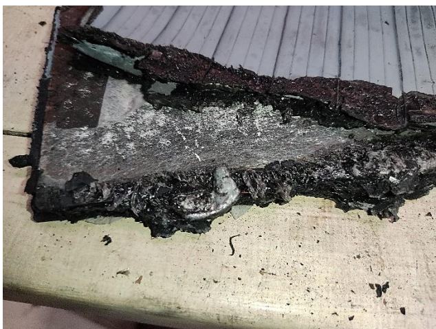
Figuras 16 a 19 - Fonte: autor (2025) - Formação de cristais de sulfato de chumbo nas placas internas, deterioração da grade, indicando sulfatação avançada e curto-circuito.
