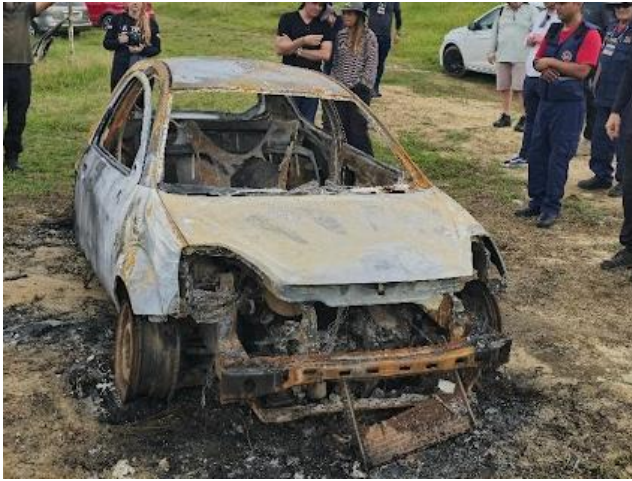
Figura 76 e 77 - Fonte: autor (2025), veículo Ford Ka, com danos por queima.
