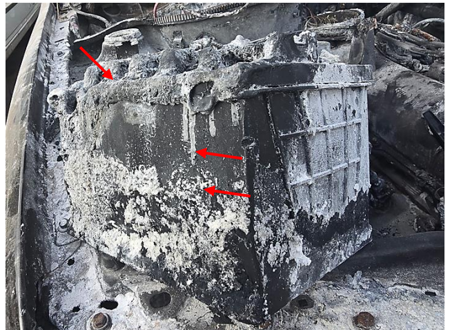
Figuras 48 e 49 - Fonte: o autor (2025) – Setas vermelhas mostram bateria apresentando anormalidades técnicas por escoamento de material eletrólito, devido ao aquecimento interno.
