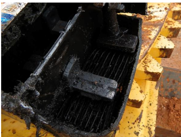
Figuras 64 e 65 - Fonte: autor (2025) – fragmentação da placa negativa de chumbo, o que promove o curto-circuito interno.
