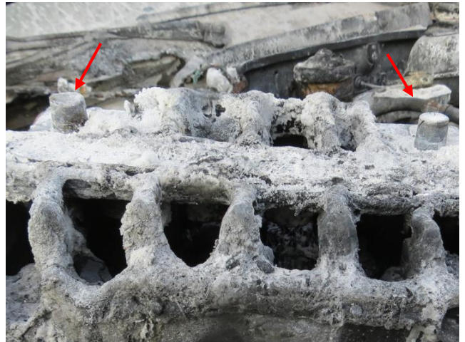
Figuras 46 e 47 - Fonte: autor (2025) – Setas vermelhas mostram polos positivo e negativo da bateria, sem anormalidades técnicas por derretimento.
