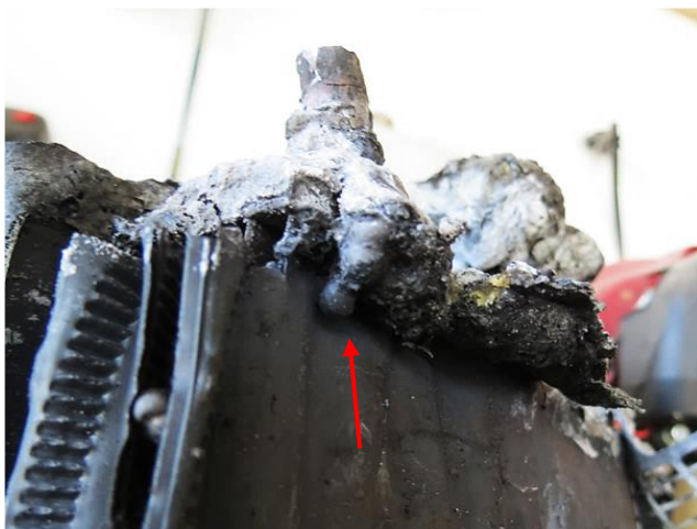
Figuras 68 e 69 - Fonte: autor (2025) - Formação de cristais de sulfato de chumbo em placas internas, indicando sulfatação avançada e curto-circuito.
