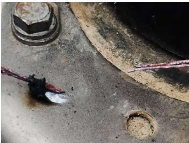
Figura 82 a 85 - Fonte: autor (2025): Teste foram realizados na fiação, para verificação da capacidade de aquecimento por resistência, condução e ruptura por arco, ocorrendo danos no isolamento e a perda de propriedades físicas materiais, gerando traço de fusão.
