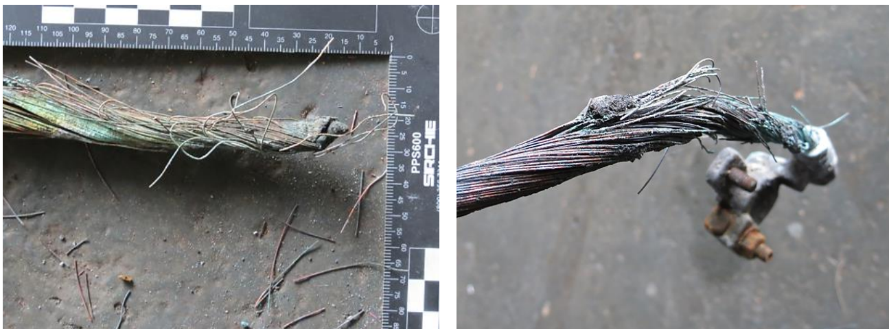
Figuras 38 a 41 - Fonte: autor (2025) – mostram compartimento veículo Frontier, danificado por incêndio, e compartimento do motor cabo elétrico positivo e soquete com danos por ação térmica, com fusão, formação de perola e superaquecimento.
