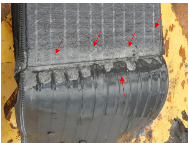
Figuras 66 e 67 - Fonte: autor (2025) detalha como se formam os cristais de sulfato de chumbo ( PbSO_4 ) nas placas internas positivas da bateria (dióxido de chumbo). Esse surgimento revela um estágio já avançado do processo de sulfatação, ligado a um curto-circuito interno e também ao depósito de uma substância pastosa / borra de composição química complexa. Tal material consiste em resíduos originados da deterioração das placas, incluindo sulfato de chumbo ( PbSO_4 ), óxido de chumbo ( PbO ), chumbo metálico ( Pb ), dióxido de chumbo ( PbO_2 ) e ácido sulfúrico ( H_2SO_4 ), prevalecendo a cor marrom.
