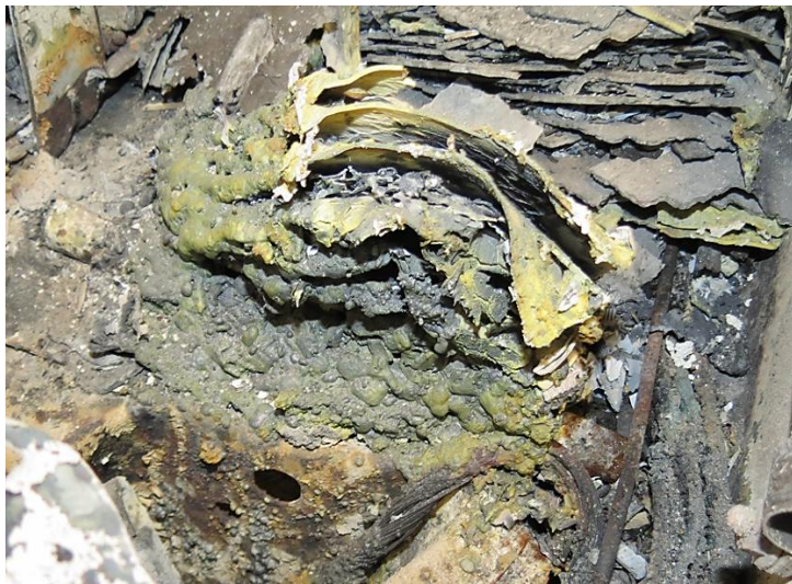
Figuras 36 e 37 - Fonte: autor (2025) – mostram baterias com danos por origem externa e interna.
