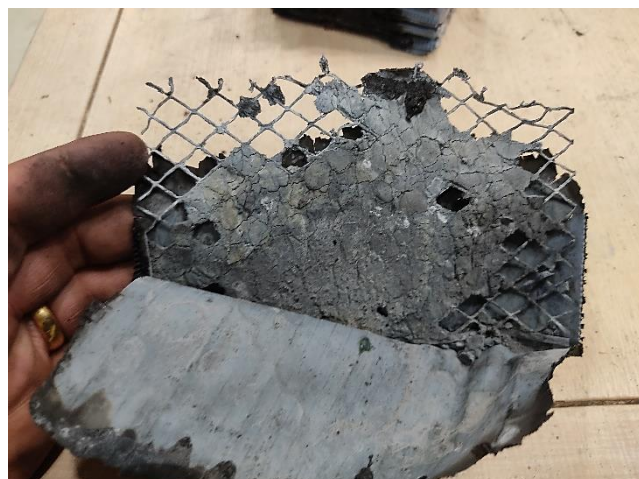
Figuras 16 a 19 - Fonte: autor (2025) - Formação de cristais de sulfato de chumbo nas placas internas, deterioração da grade, indicando sulfatação avançada e curto-circuito.
