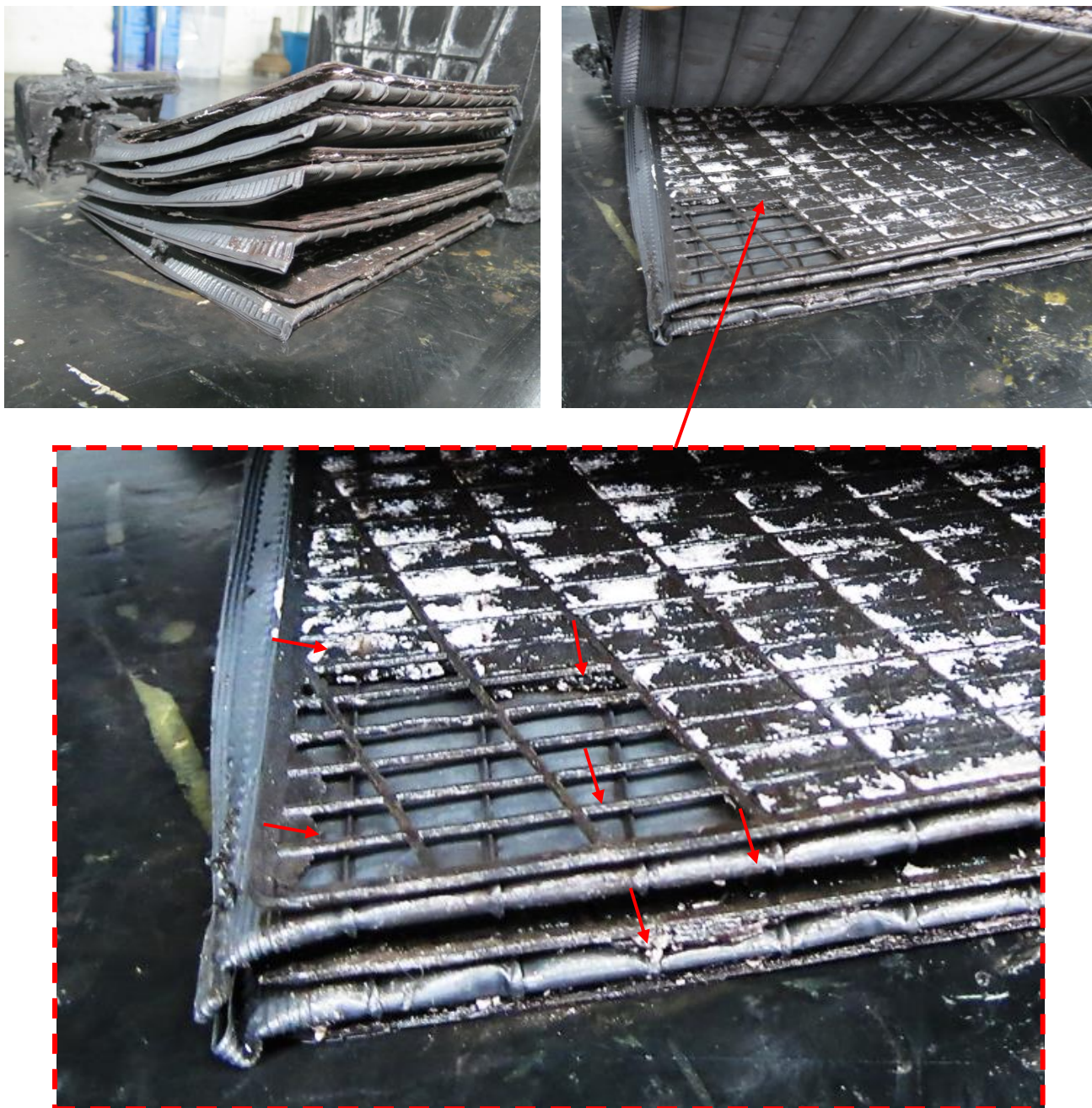
Figura 57 e 58 - Fonte: autor (2025) – Setas vermelhas mostram anormalidades técnicas por descolamento das placas de chumbo do vaso positivo, evidenciando a degradação e ruptura parcial da estrutura.
