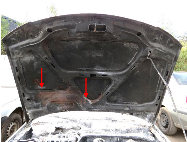
Figuras 42 e 43 - Fonte: autor (2025) – Setas vermelhas mostram motor com danos por queima e concentração do lado direito, com orientação de trás para frente.
